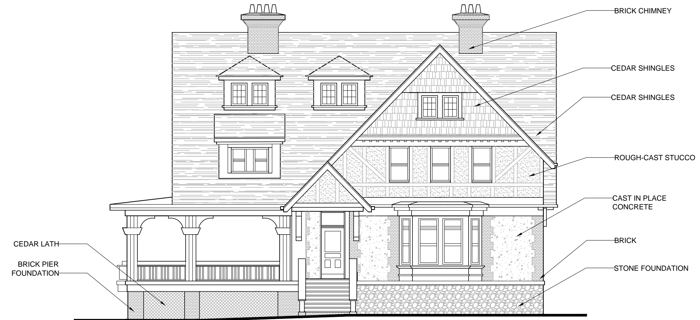
2 SOUTH ELEVATION A5 1/8" = 1'-0"
